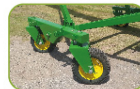
Detalle de accesorio para chasis de movimiento lateral
