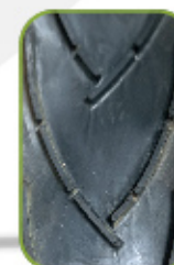
Detalle banda 160 mm de ancho
