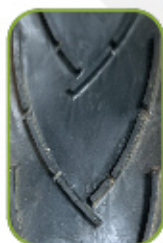
Detalle banda 160 mm de ancho
